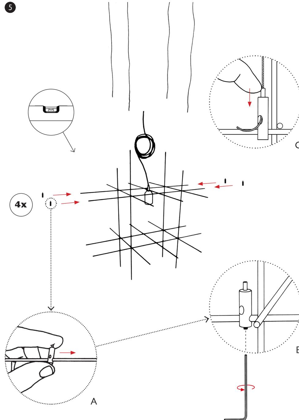
Blenden montieren / Attach the shades / Monter les écrans / Montare i paralumi
